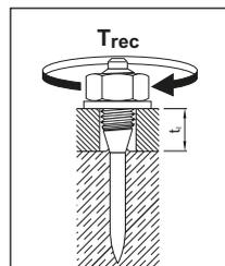
$$T_{rec} \leq 6 \text{ Nm}$$
