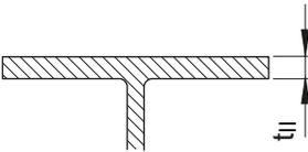
Steel:  $t_{II} \geq 4 \text{ mm}$
