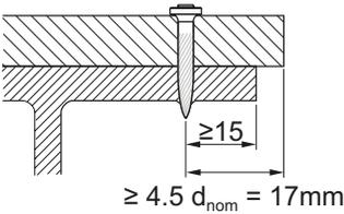
Edge distance:  $c \geq 15 \text{ mm}$
