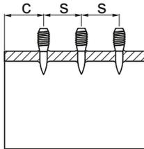
Edge distance:  $c \geq 15 \text{ mm}$
