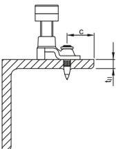
Edge distance:  $c \geq 15 \text{ mm (0.59")}$
