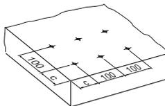
Edge distance:  $c \geq 70 \text{ mm}$
