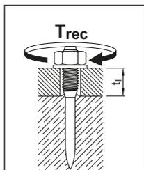
$$T_{rec} \leq 4 \text{ Nm}$$
