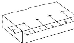
Edge distance:  $c \geq 70 \text{ mm}$
