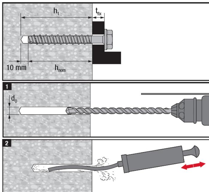
Le nettoyage du trou n'est pas nécessaire après 3 aller-retours<sup>1)</sup> si l'une des conditions suivantes est remplie :
