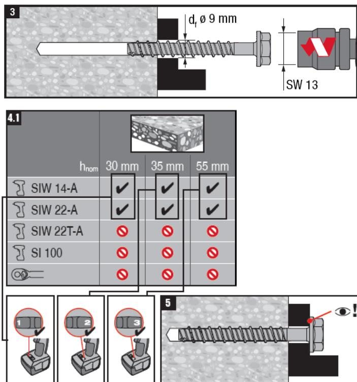
Installation manuelle des vis HUS4-HR, CR ; HUS-HR, CR dans un élément support en béton n'est pas permise (installation à la boulonneuse uniquement).
