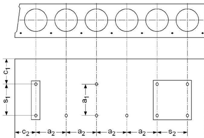
Minimaler Randabstand  $c_{\min} \geq 100 \text{ mm}$
