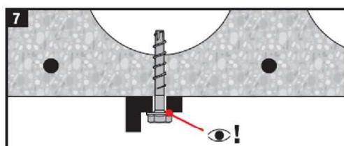
Die Installation mit elektrischen Tangential-Schlagschraubern gleicher Kraft und Leistungsstärke ist möglich.
