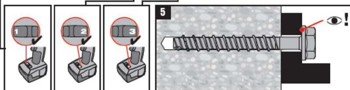
Die Installation mit elektrischen Tangential-Schlagschraubern gleicher Kraft und Leistungsstärke ist möglich
